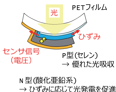
図1. デバイス構造
